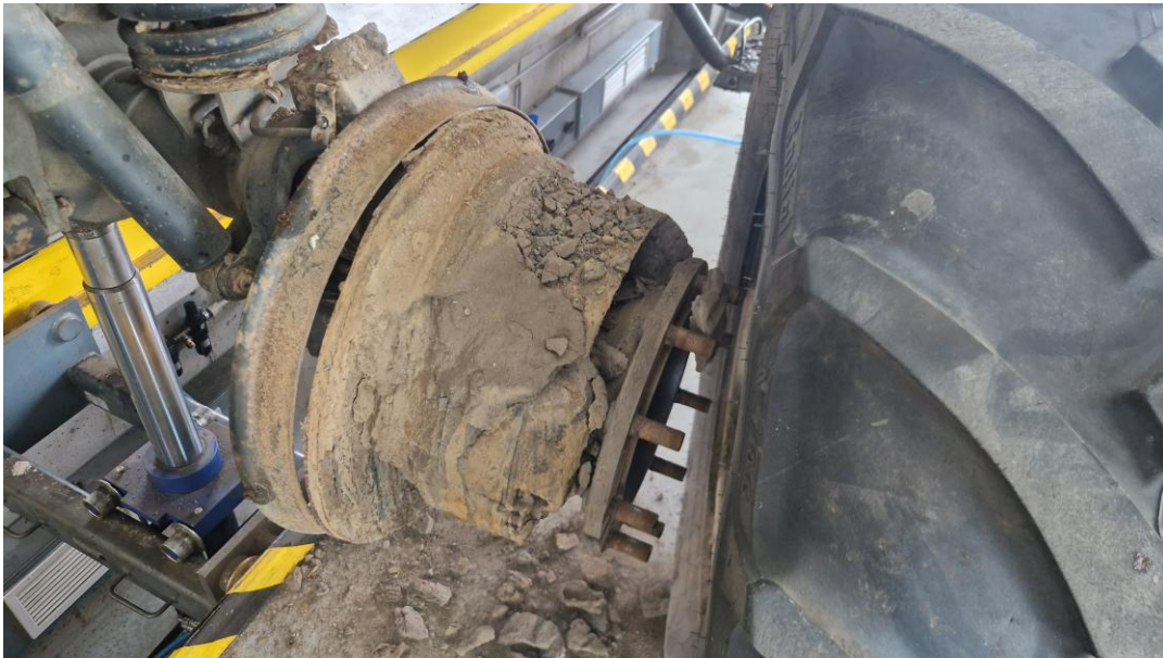
2. ábra Megszilárdult sárral teli fékrendszer
