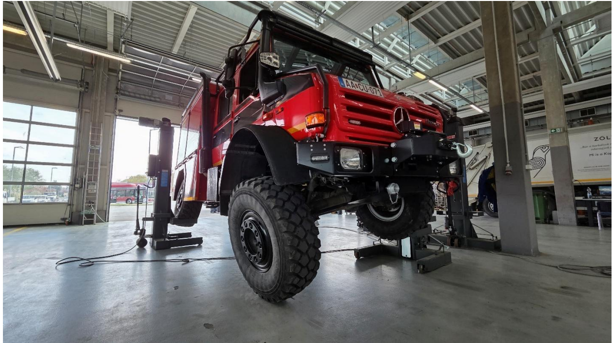
9. ábra A torzió tesztelés
