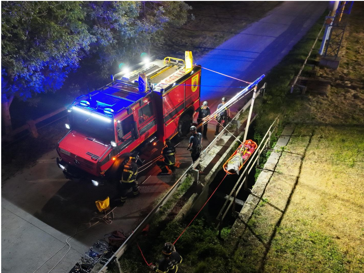
14. ábra Monopod / gin pole
